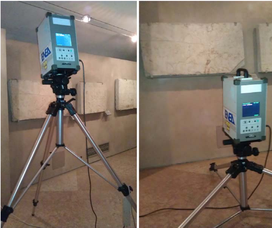
Figura 2- Fase di acquisizione con scanner laser da due diverse angolazioni svolta presso il Museo Archeologico di Bologna
